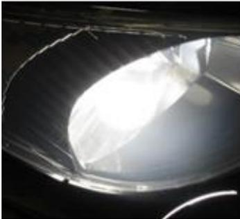
・レンズ内部の白濁（レンズ内部も塗装されているレンズがあり、レンズ表面と同様に劣化していきます。本製品は表面を補修するものであり、内部までは補修できません）
