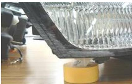
・輪郭部のボディ一部（黒色部）とレンズ部の異種素材同士が隙間なく隣接しているため、またボディ一部は肉が薄くなっているため
