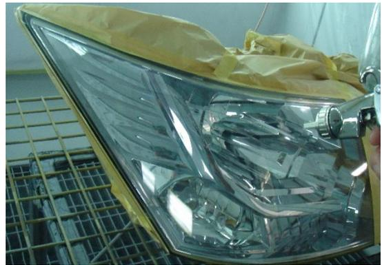
注) ○硬化剤は必ず正確に計量してください。硬化剤は少ないと、硬化不良を起こし傷が付き易くなります。
