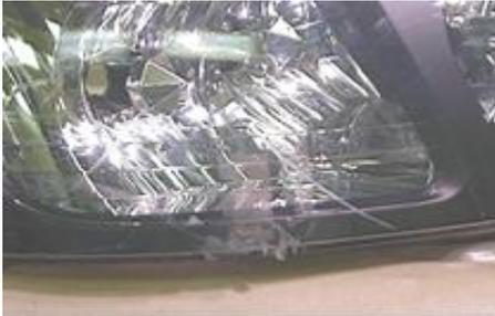
・表面のみならず素材の深くまで切削されているような傷
